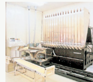
緻密な計測を可能とする粉体自動計量器での品質管理
